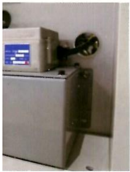
旋轉尾座 高挾持與高推力的尾座設計，使加工長工件時維持良好的穩定度。
